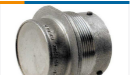
TE Part #HDC34-24-1E DUST CAP, 24SZ, PLG, AL, NO LANYARD,HD30
