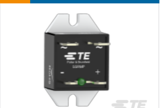
TE Part #2323802-3 SSRMP-240D10 = Mini Puck, 10A, 240V AC
